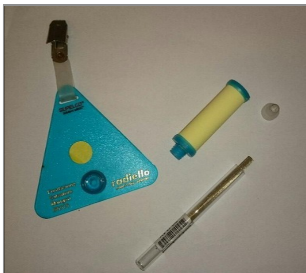
Figure 11 : Dispositif d'échantillonnage passif par cartouche de prélèvement Radiello 145©.
