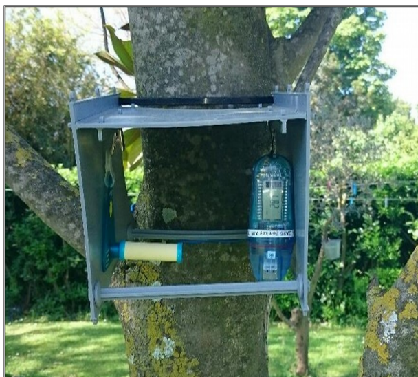
Figure 11 : Dispositif d'échantillonnage passif par cartouche de prélèvement Radiello 145©.
